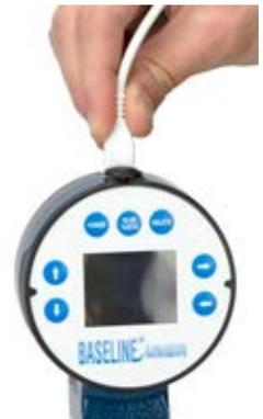
Lade-/Datenkabel (Micro-USB) in Steckerbuchse am Prüfstandskopf einstecken
